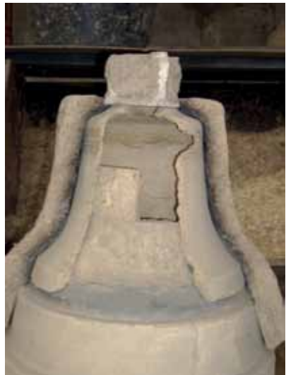
Halb geöffnete Glocken-Gussform
